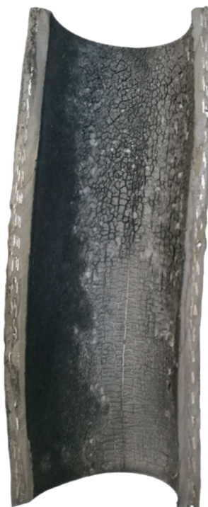
Wettbewerbsprodukt vs. Goodall Inferno Popcorning-Effekt
